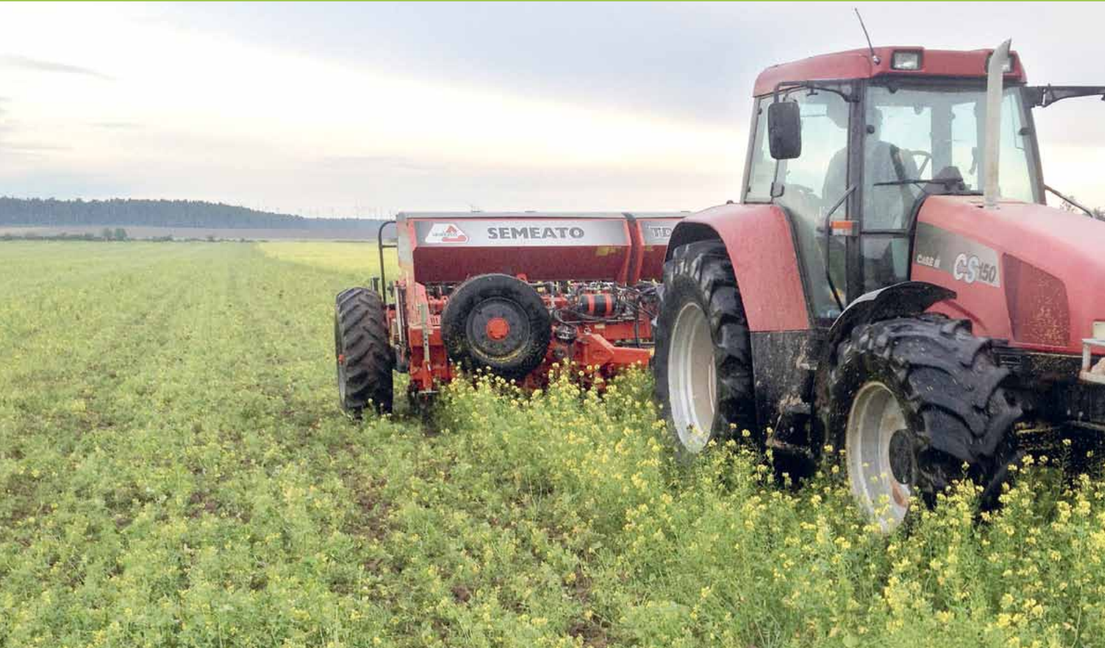
Direktsaat von Wintergetreide in eine stehende Zwischenfrucht mit der brasilianische Scheibenschar-Sämaschine Semeato TDNG 4.5.
